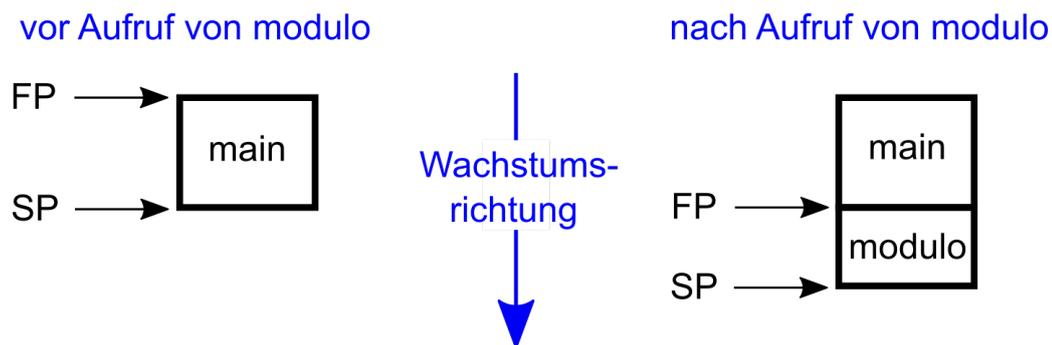
Aus dem Gesamtlayout des Adressraums wird deutlich, dass der Stack in Richtung kleinerer Adressen wächst: Der Wachstumsrichtungspfeil in der letzten Abbildung zeigt nach unten, in der Abbildung von Seite 2 allerdings nach oben. SP ist also immer kleiner als FP, genauer gesagt gilt im Beispiel nach dem Aufruf von *modulo* :
